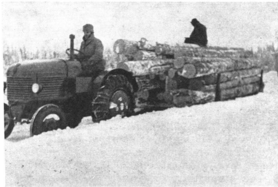
Pyörätraktorit ovat uusimpia tulokkaita metsätyömailla. Tässä itävaltalainen Steyr-traktori vetämässä 250 j 3 kuormaa. Osa kuormasta on traktorin taka-akselin varassa. (Metsäteho).
