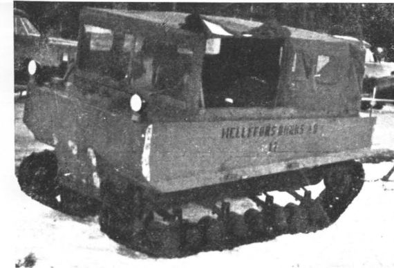
Amfibiovaunu pystyy kulkemaan pehmeilläkin soilla sekä lumessa. Se soveltuu siten mainiosti huoltokuljetuksiin sekä lumen tiivistämiseen turvemailla, heikolla jäällä, varastoalueilla yms. (Metsäteho).
