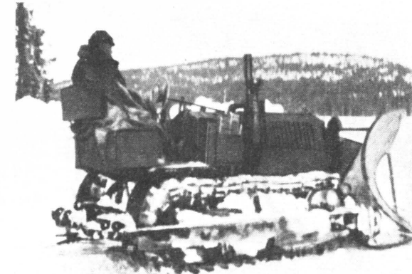
Telaketjutraktorilla voidaan teiden raivaus suorittaa taloudellisesti. Lisäksi sitä voidaan käyttää talviteiden auroiksiin vaikeissakin lumiolosuhteissa. (Kuvat Työtehosteuran kokoelmista).
