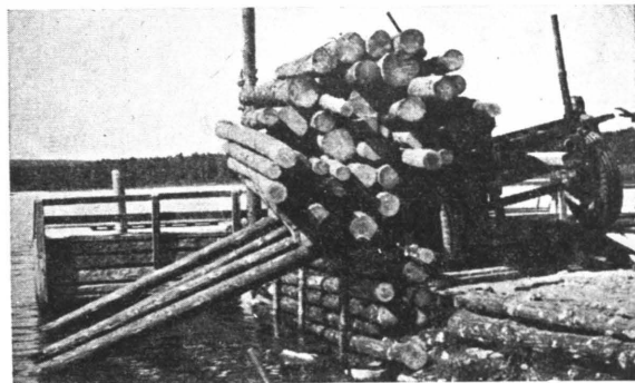
Auton lavalla tehdyt tukkiniput pudotetaan veteen telasiltaa pitkin ja kallistuskorokkeita antaa pyörien alla käyttäen (Metsäteho).
