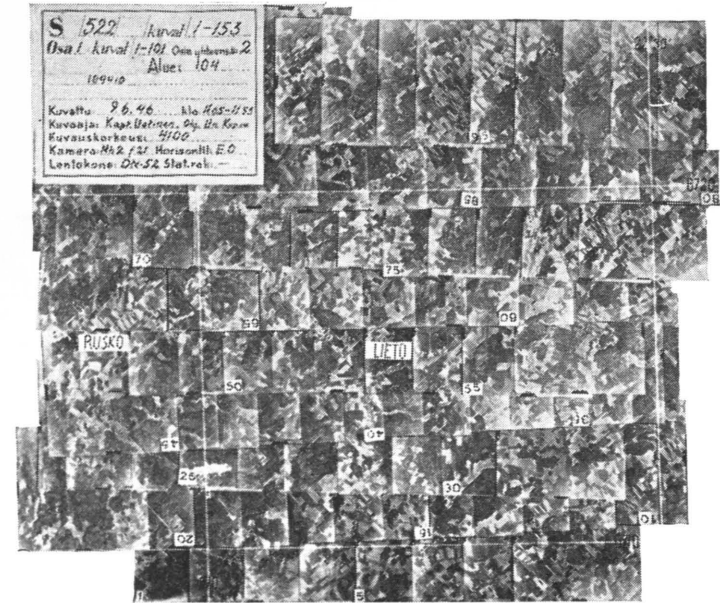
Kuva 8. Kuvarekisteri, joka osoittaa yhdellä lennolla peitetyn alueen ja josta ilmakuvien numerot ilmenevät. (Löfström 1946).
