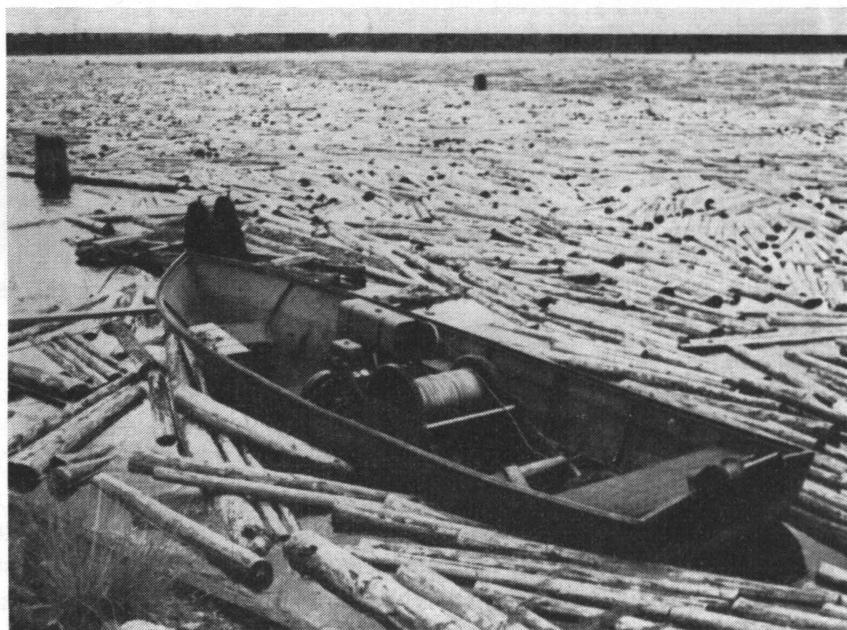
Kuva 8. Moottorivarppaaja Oulujoen vesistöstä (rak. v. 1955, 10 hv). Valok. Elias J. Purhonen. Fig. 8. A motor-powered warping boat on the Oulujoki Water System, built in 1955, 10 H.P. Photo Elias J. Purhonen.
