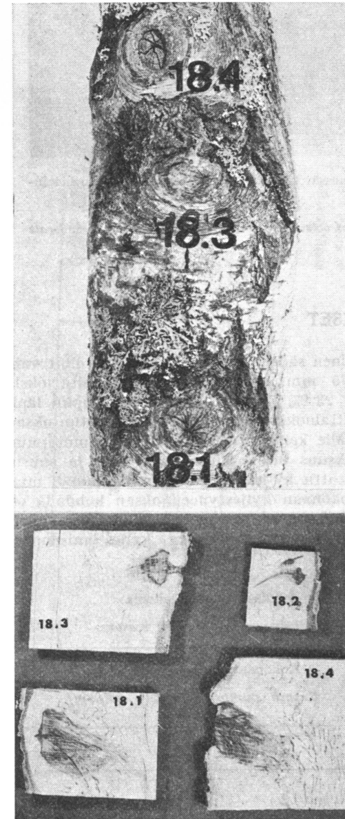
Kuva 1. Näytepölkky n:o 18 ja sen oksien halkileikkaukset.
