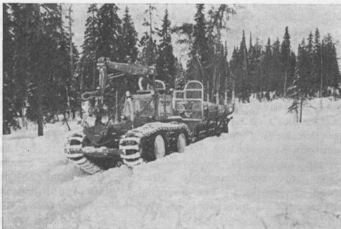
f. Another tracked forwarder with a sled in the winter tests. — Toinen telapyörätraktori rekineen talvikokeissa.
