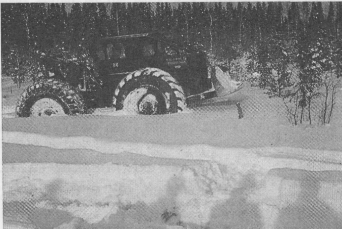
c. A skidder driving empty on untouched snow. — Laahuspyörätraktori tyhjänäajossa umpilumessa.
