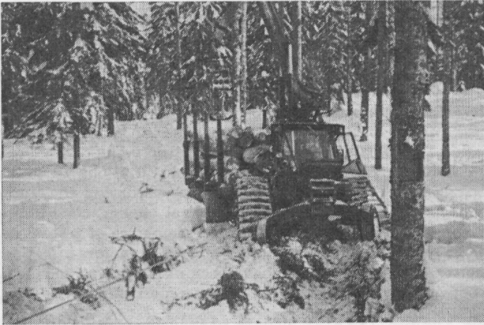
a. A half-tracked tractor with a half load in a winter test. — Puolitelatraktori puolella kuormalla kuormattuna talvikokeissa.
